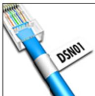
fixez l'étiquette sur le câble, ses deux extrémités sont collées dos à dos, donnant l'effet d'un drapeau. Les deux côtés de l'étiquette sont ainsi parfaitement lisibles.
