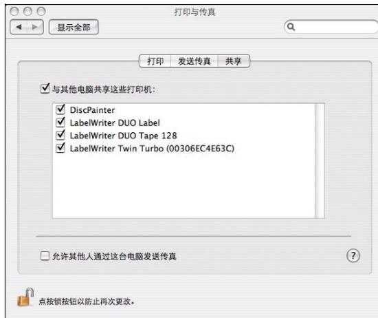
**注意** 要共享在标签和条带上都能进行打印的 DYMO LabelWriter Duo 打印机，请同时选择 LabelWriter DUO Label 打印机和 LabelWriter DUO Tape 128 打印机。
