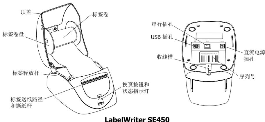
打印机前面的换页按钮用于推进一张标签。反转标签按钮用于在更换标签卷时从打印机上取下标签。LabelWriter SE450 打印机没有反转标签按钮。
