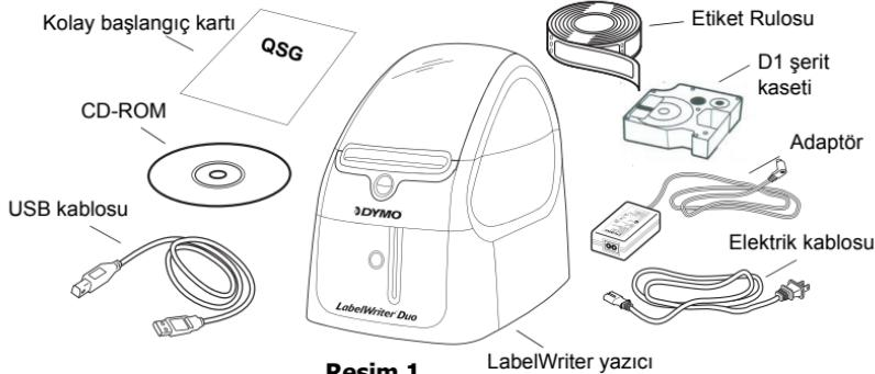
LabelWriter yazıcınız direkt termal bir yazıcıdır ve toner, kartuş veya ribbon kullanmaz. Tüm bunların yerine özel üretim etiketlere baskı yapmak için termal baskı kafasının ürettiği ışığı kullanır. Satın almanız gereken tek sarf malzemesi etiketlerdir.
