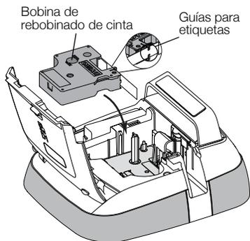
Si fuera necesario, gire la bobina de rebobinado en el sentido de las agujas del reloj para tensar la cinta de impresión.
