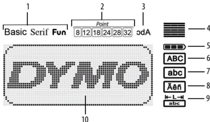
Die Funktionsanzeige am oberen Rand des LCD-Displays wird schwarz angezeigt, wenn eine Funktion ausgewählt ist.
