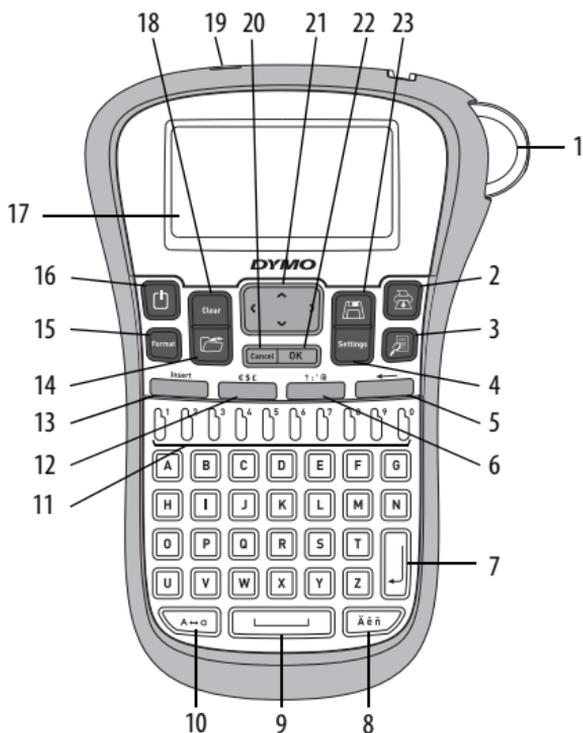
**Abbildung 1** DYMO® LabelManager 260P Elektronisches Beschriftungsgerät
