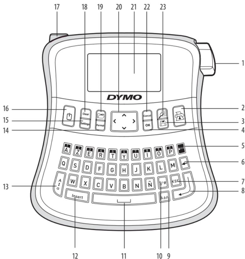
**Figure 1 Étiqueteuse électronique LabelManager 210D**
